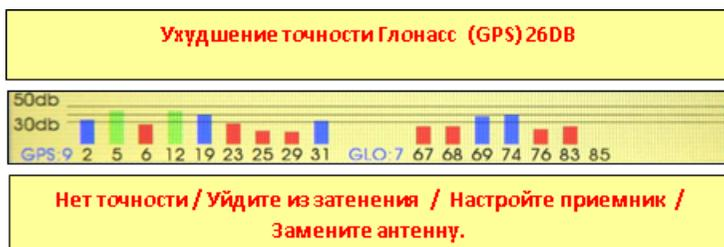
спутников на экран выводится информация о появившейся неисправности.
